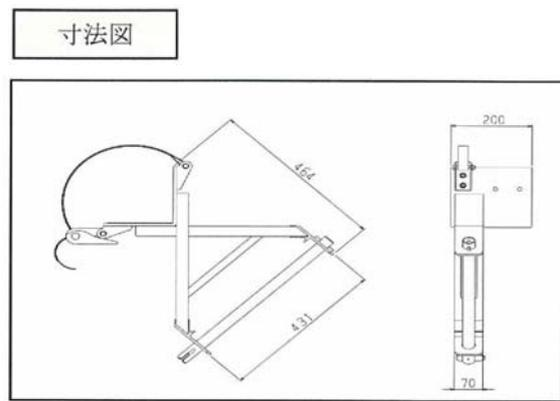
**指定鉄骨柱** 設置できる鉄骨柱は、一辺が300~650mmのコラム・H・I型の鉄骨柱です。指定以外の鉄骨柱に設置しないで下さい。
